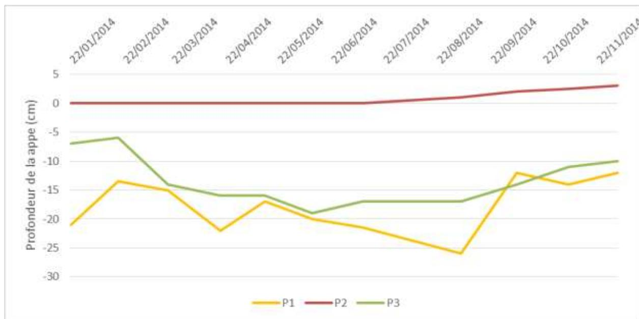
Figure 11 Fluctuations du niveau de la nappe dans les piézomètres à relevés manuels sur le site témoin.
