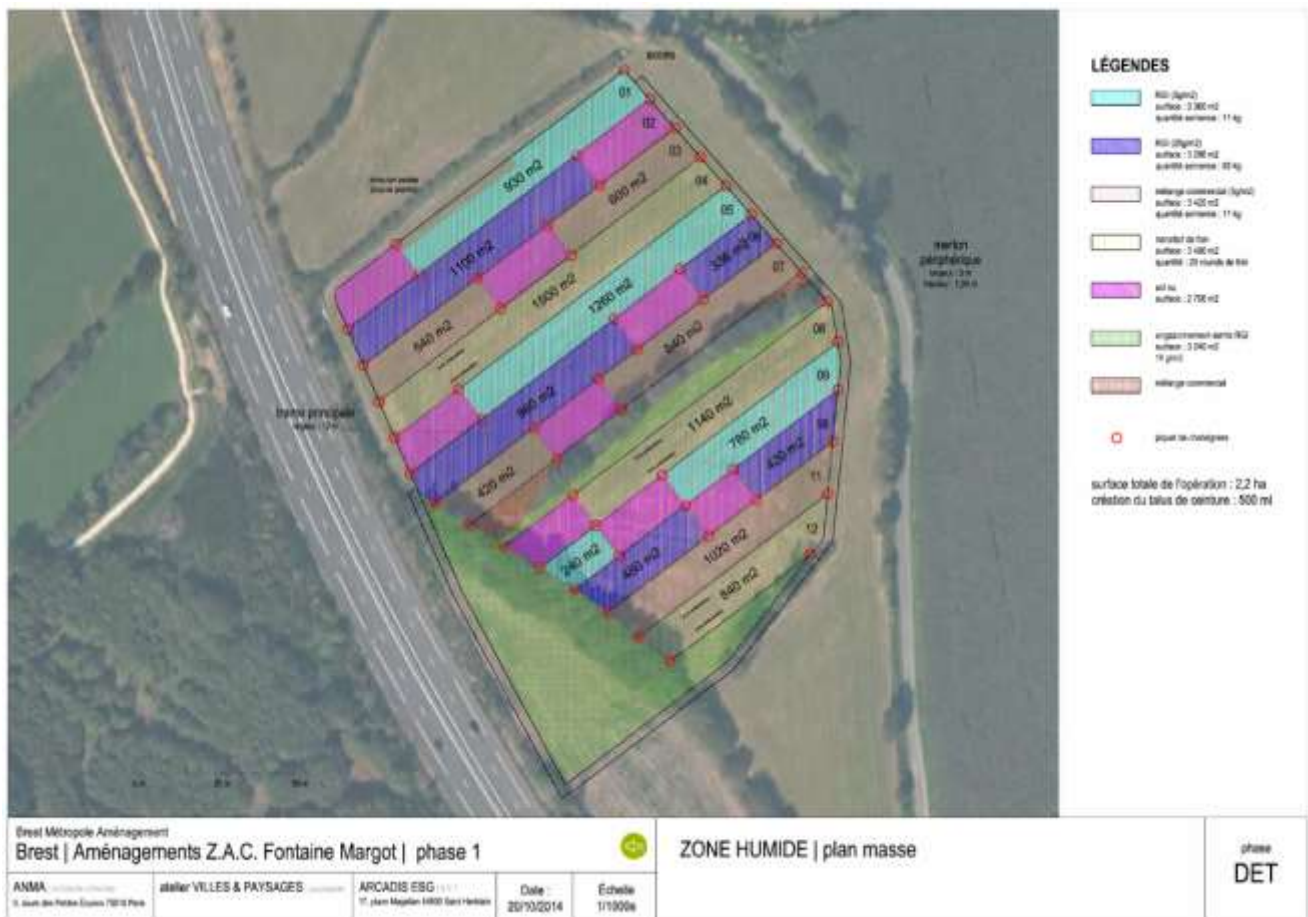
Figure 17 Protocole expérimental de semis. Chaque couleur correspond à un type de semi, le rose au sol nu.
